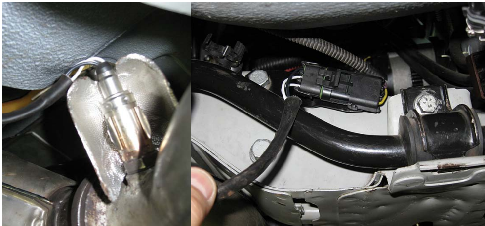
Slika 20: kisikova (lambda) sonda in priključni konektor
