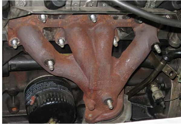
Slika 15: Pritrditev kolektorja na glavo
