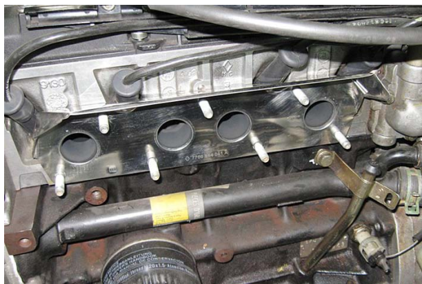
Slika 17: Nameščeno novo tesnilo
