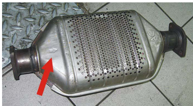
Slika 23: puščica ki kaže smer montaže
