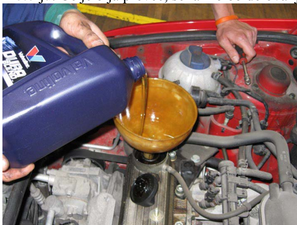
Slika 1: Nalivanje motornega olja
