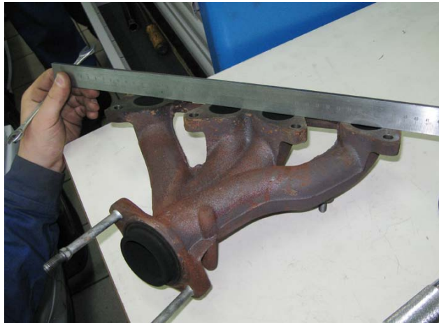
Slika 16: Preverjanje ravnosti kolektorja
