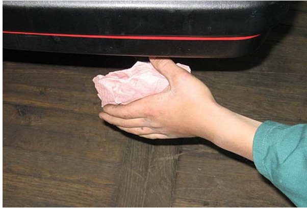
Slika 12: S krpo preverjamo tesnost sistema
