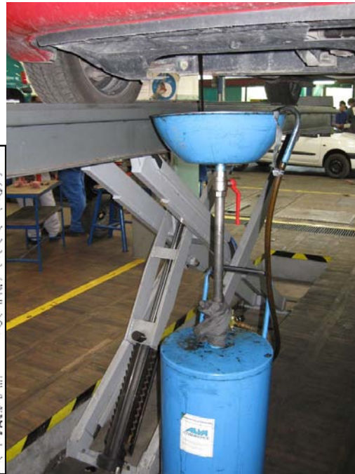
Slika 2: Izpuščanje olja v posebno posodo
