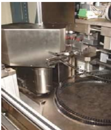
Slika 14: Oblikovanje jeklenih linij za rotacijsko izsekovalno orodje
