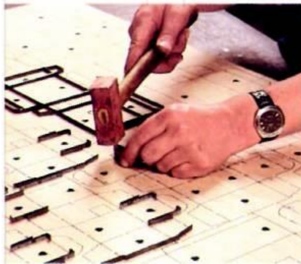
Slika 9: Vstavljanje jeklenih linij
