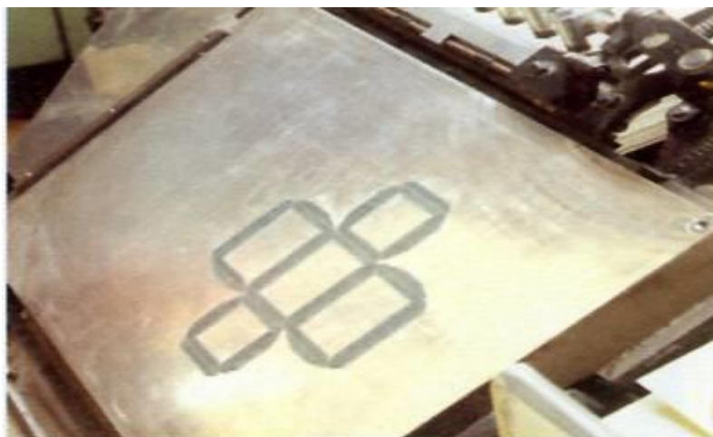
Slika 41: Žlebilna priprava v zaklopnem izsekovalnem stroju
