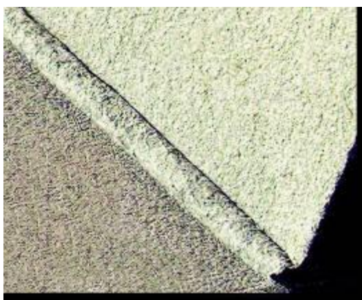
Slika 26: Dobro in slabo žlebljenje kartona (povečan prikaz)
