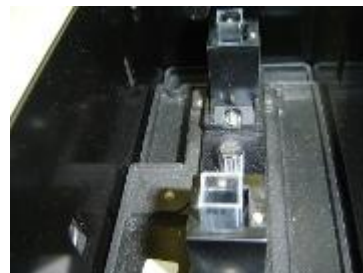
Slika 3 - 7 Izpopolnjeni dvožarkovni spektrometer in notranji del s kivetama.
