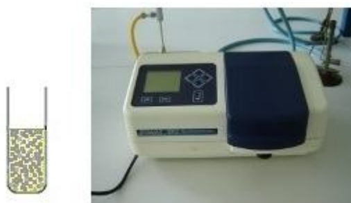
Slika 4 - 13 Spektrometer, ki meri koncentracijo snovi na osnovi merjenja motnosti vzorca.
