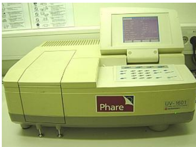
Slika 3 - 7 Izpopolnjeni dvožarkovni spektrometer in notranji del s kivetama.
