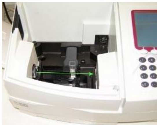
Slika 3 - 5 Vstavljiva kiveta v enožarkovnem spektrometru
