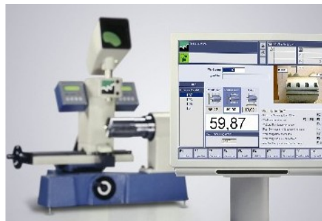
Slika 12: Optični mikroskop za merjenje geometrije rezalnega orodja
