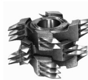
Slika 62: Čepilni stroj in rezkalno orodje za izdelavo zobate vezi
