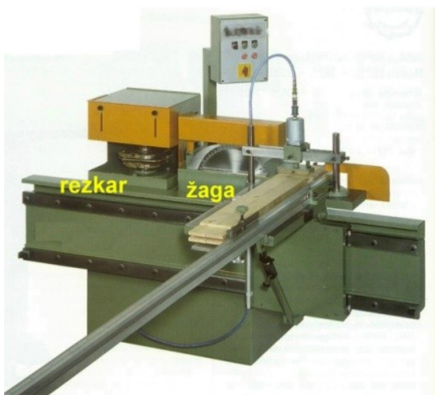
Slika 62: Čepilni stroj in rezkalno orodje za izdelavo zobate vezi
