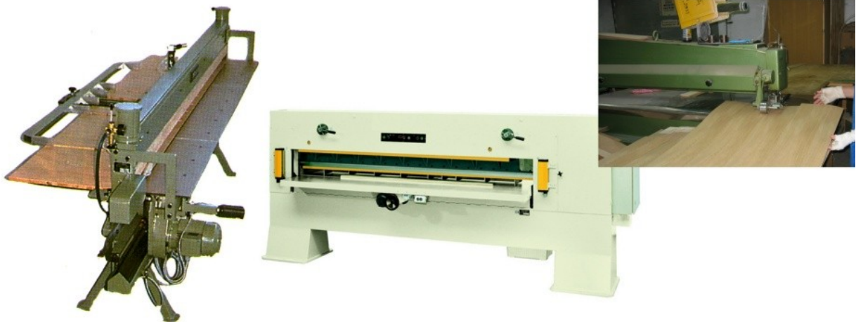
Slika 40: Paketni rezkalni stroj, paketne škarje in stroj za spajanje furnirja (z leve)
