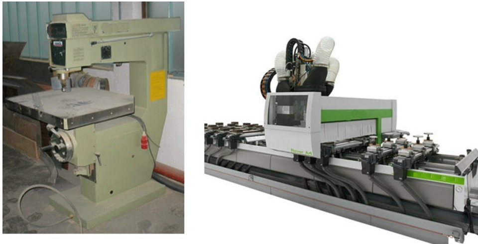
Slika 36: Nadmizni rezkalni stroj in sodobni CNC-nadmizni obdelovalni center
