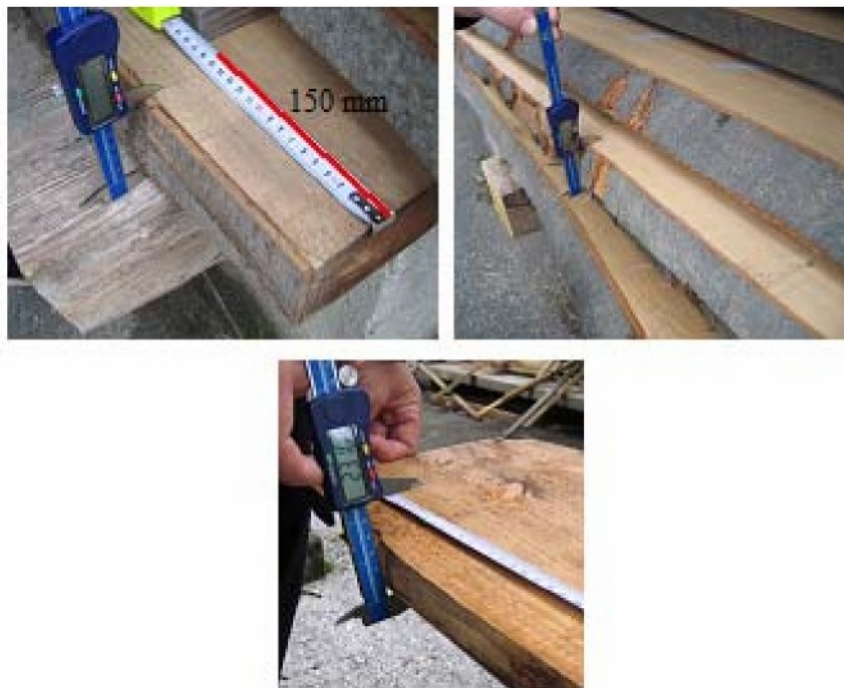
Slika 2 Merjenje debeline žaganic
