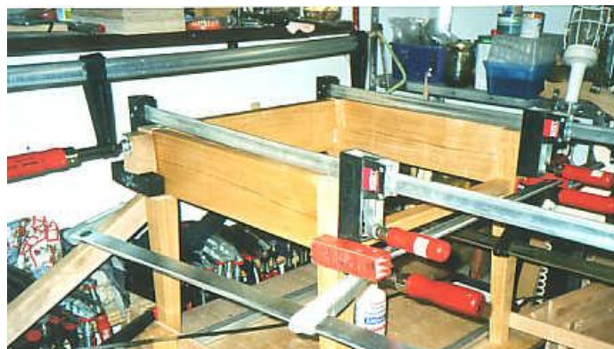
Slika 26: Stiskanje podnožja stolčka z mizarskimi sponami
