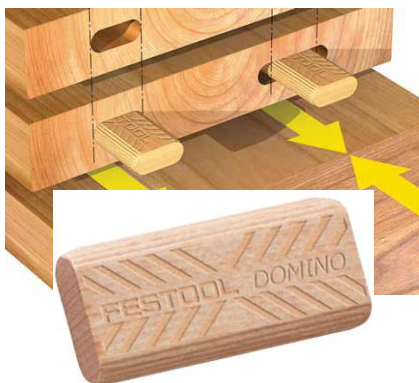
Slika 32: Sistem DOMINO, ročni rezkalni stroj za izdelavo lukenj za vstavljive čepe
