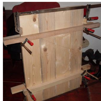
Slika 16: Stiskanje lepljenecv po širini
