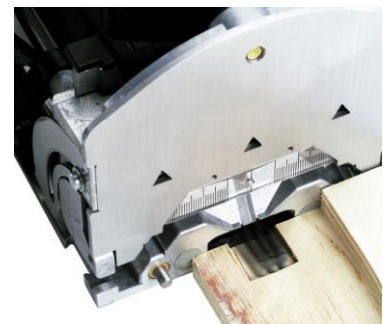
Slika 32: Sistem DOMINO, ročni rezkalni stroj za izdelavo lukenj za vstavljive čepe
