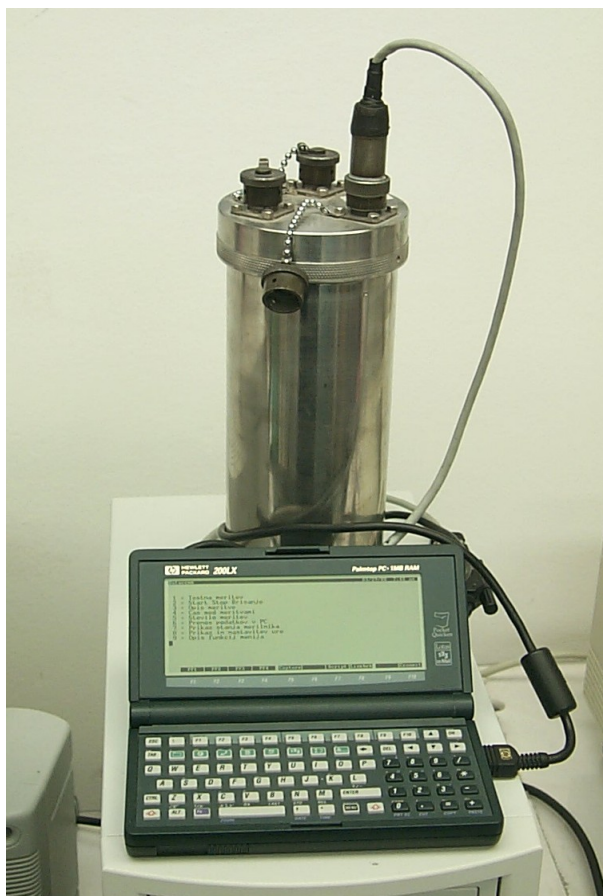
Slika 13: Prikaz priključitve računalnika HP 200 LX na avtomatski registrator STIX
