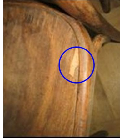
Slika 19: ...manjkajoči furnir na površini sedežne plošče zakrpamo...
