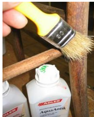
Slika 24: ...luženje – izenačevanje površine z lužilom ...
