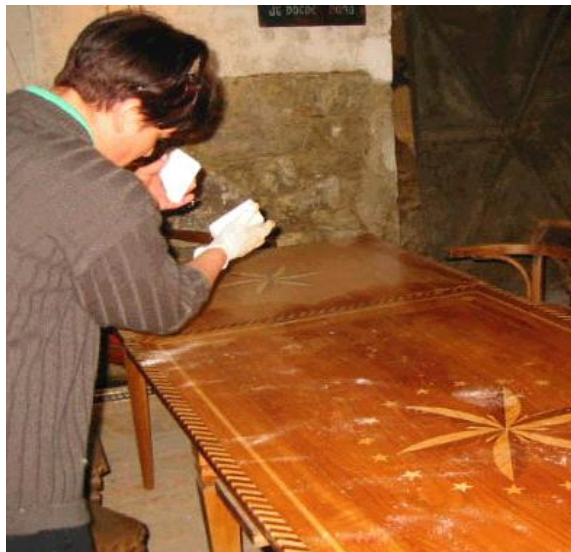
Slika 40: ...polnjenje por s plovčevim prahom...
