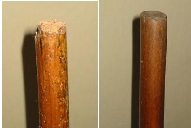
Slika 18: Spodnje del nog, ki so jih napadli insekti, smo zamazkali..
