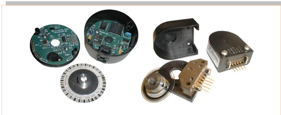
Slika 2.7: Različni tipi optičnih inkrementalnih dajalnikov stanja
