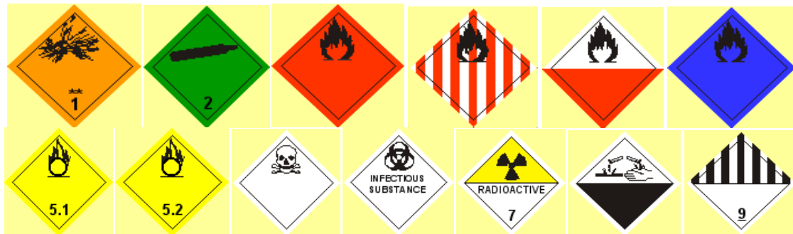
Slika 55: Opozorilni znaki (Prva vrstica od leve proti desni: Eksplozivne snovi, Komprimirani plini, Vnetljive tekočine, Vnetljive trdne snovi, Samovnetljive snovi, Snovi, ki pri stiku z vodo razvijejo vnetljive pline; Druga vrstica od leve proti desni: Oksidirajoče snovi, Organski peroksidi, Strupi, Kužne snovi, Radioaktivne snovi, Jedke snovi, Ostale nevarne snovi) ( http://sl.wikipedia.org/wiki/Nevarne_snovi )
