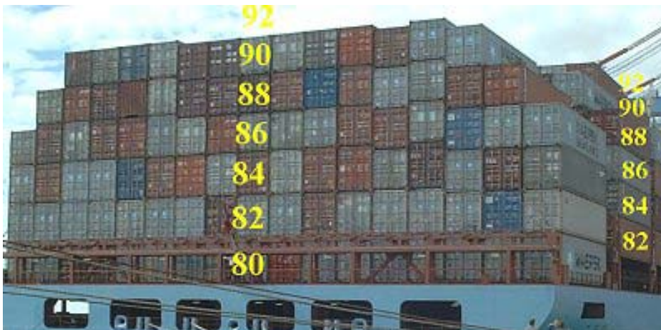
Slika 14: številčenje vodoravnih slojev. Vir: www.tis-gdv.de (2011)
