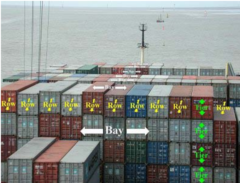
Slika 4: načelo koordinatnega sistema odseka, vrste in sloja (bay-row-tier). Vir: www.tis-gdv.de (2011)
