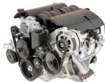
Slika 41: Avtomobilski motor (Chevrolet v8).
